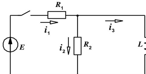
$E=200\text{ В}$ ,  $R_1=40\text{ Ом}$ ,  $R_2=60\text{ Ом}$ ,  $L=120\text{ мГн}$ .
